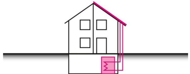
Mit einer gut platzierten Sonnenkollektoranlage (thermische Solaranlage) auf Ihrem Hausdach können Sie bis zu zwei Drittel der Energie für die Warmwassererwärmung bereitstellen. Dank moderner Technik auch im Winter und bei bedecktem Himmel. Noch mehr Energie sparen Sie, wenn Sie das von der Sonne erwärmte Wasser mit einer kombinierten Lösung auch zum Heizen verwenden.
