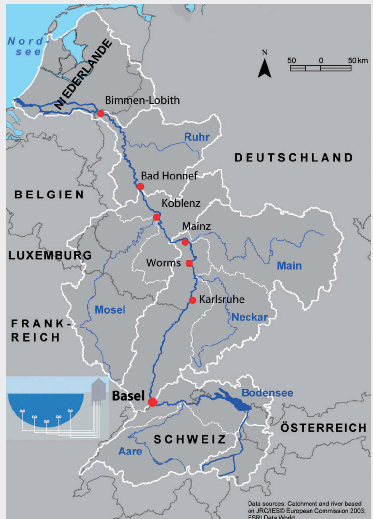
Fig. 1 Das Einzugsgebiet des 1230 km langen Rheins umfasst 200 000 km 2 . Eingezeichnet sind die 7 Rheinmessstationen, die im Überwachungsnetz der IKSR zusammengeschlossen sind. Die RÜS bei Basel betreibt im Flussbett des Rheins fünf Entnahmestellen mit je doppelsträngigen Leitungen (Kunststoff und Stahl) für die Analytik von Metallen, Nährstoffen und organischen Spurenstoffen Le bassin versant du Rhin, long de 1230 km, englobe 200 000 km 2 . Sont tracées les 7 stations de mesure sur le Rhin, regroupées dans le cadre du réseau de surveillance de la CIPR. La SSR près de Bâle exploite 5 points de prélèvements dans le lit du Rhin, avec des conduites bi-tubes (plastique et acier) pour l'analyse de métaux, substances nutritives et éléments traces organiques
