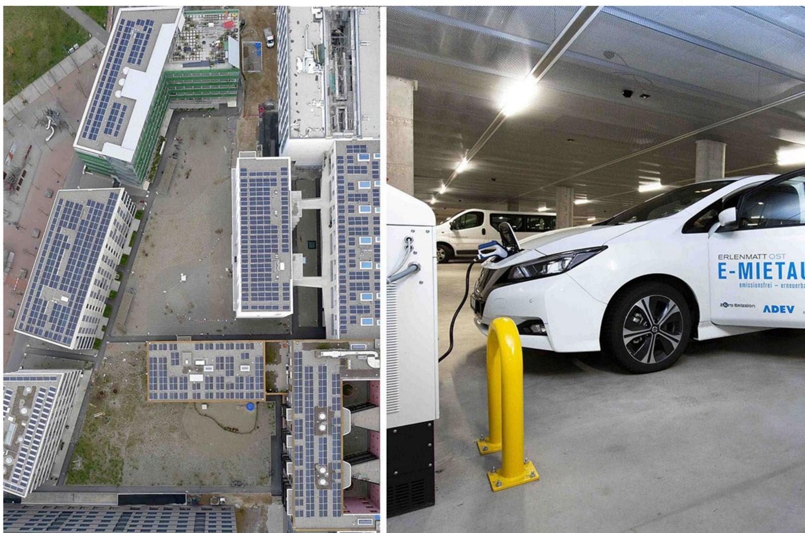
Un projet pilote de couplage de secteurs est en cours dans le quartier d'Erlenmatt. L'électricité solaire produite sur les toits est utilisée pour recharger les voitures électriques. Mais l'électricité stockée dans les batteries des voitures peut aussi être réinjectée dans le réseau des bâtiments en cas de pics de demande.
